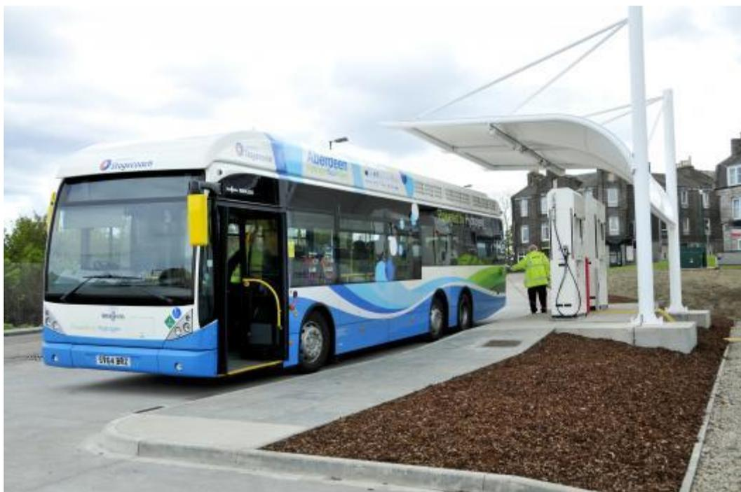
Figura 1. Autobus H2 durante il rifornimento presso la colonna "dispenser".<sup>8</sup>
